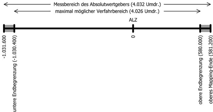
Hier wurde das obere Mapping-Ende vom Wert 806.400 auf den Wert 581.200 verringert. Somit liegen ein höherer Anteil des möglichen Verfahrbereichs im negativen Bereich und ein kleinerer Anteil im positiven Bereich.
