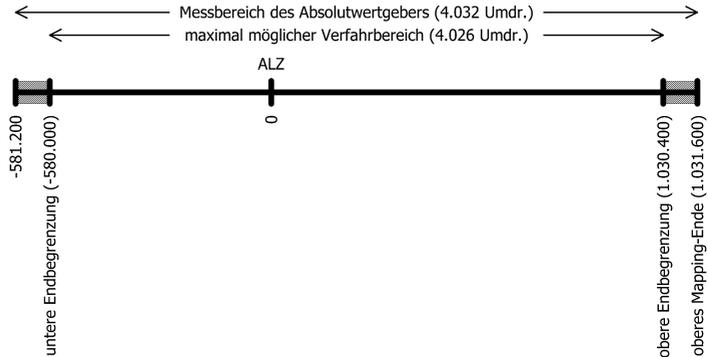
Hier wurde das obere Mapping-Ende vom Wert 806.400 auf den Wert 1.031.600 erhöht. Somit liegen ein höherer Anteil des möglichen Verfahrbereichs im positiven Bereich und ein kleinerer Anteil im negativen Bereich.
