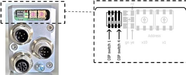
Nach dem Entfernen des Verschlussstopfens gelangen Sie an die Bedien- und Status Elemente. Zum Verstellen der Schalter benötigen Sie einen nicht-leitenden spitzen Gegenstand.
