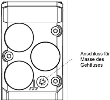
Das PSD4xx muss geerdet werden, bevor die Versorgungsleitung angeschlossen wird. Das Erdungskabel muss dazu an der vorgesehenen Position am PSD4xx fixiert und auf Erdpotential (z. B. Maschinenbett) gelegt werden.
